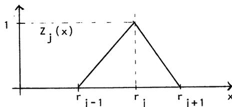
$Z_j(x) = I_j(x) \cdot (x - r_{j-1}) / (r_j - r_{j-1}) + I_{j+1}(x) \cdot (r_{j+1} - x) / (r_{j+1} - r_j)$ , con las lógicas modificaciones  $Z_1(x) = 1$  si  $x < r_1$  y  $Z_J(x) = 1$  si  $x > r_J$ . (Con  $I_j$  representamos el indicador del intervalo  $[r_{j-1}, r_j]$ ).
