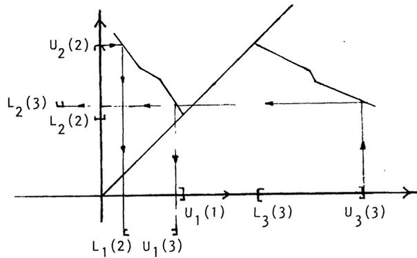
La intersección  $\bigcap_{i=1}^n (L_j(i), U_j(i))$  nos da el intervalo solución  $(L_j, U_j)$  para  $r_j$ . En este ejemplo, cada  $L_j$  ha resultado menor que el correspondiente  $U_j$ ; todos los intervalos  $(L_j, U_j)$  son no vacíos y tenemos caracterizado el conjunto de todas las soluciones.
