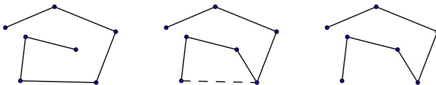
Figura 5: Transformación local en cadenas poligonales abiertas. Se añade una arista conectando uno de sus extremos a un vértice visible y se elimina la arista adecuada para obtener de nuevo una cadena poligonal abierta.
